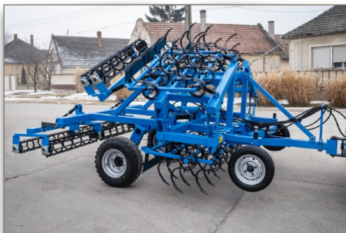
5,6m vontatott hidraulikus kombinátor
