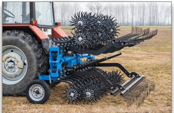
6m függesztett, gyomfésűvel
