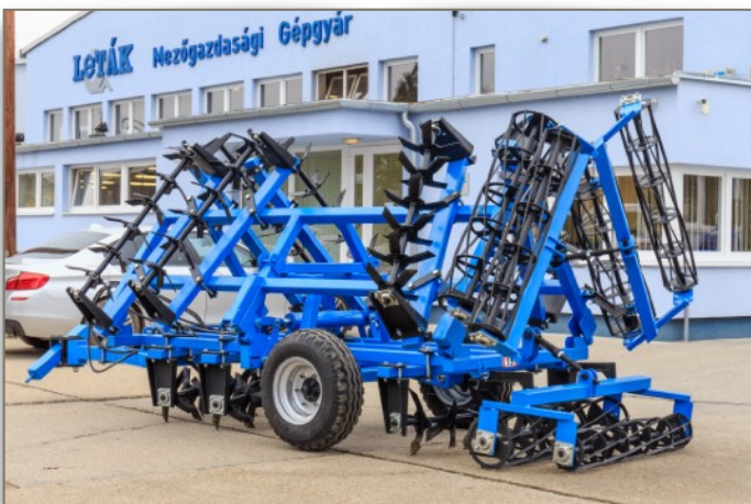
4,2m vontatott, hidraulikus ásóborona
