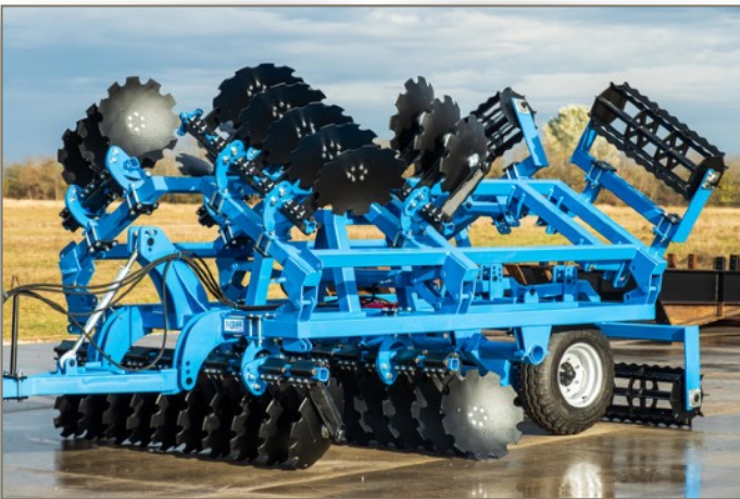
4,5m hydr., vontatott, csipkés hengerrel
