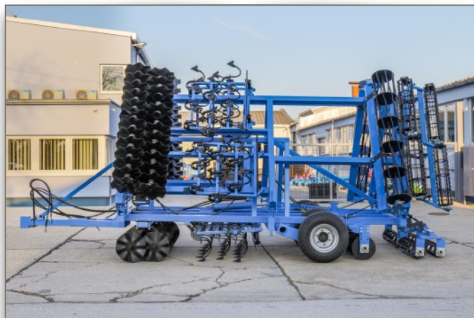
6,6m vontatott hidraulikus kompaktor
