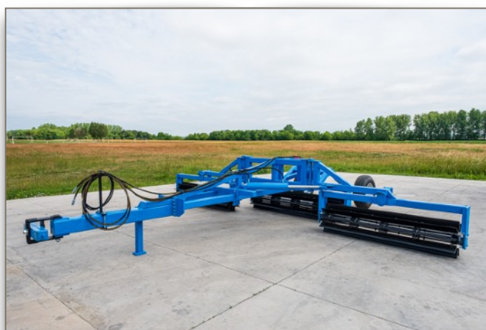
6m vontatott aprító henger
