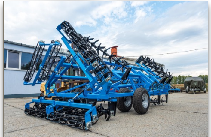
6,2m vontatott, hidraulikus ásóborona
