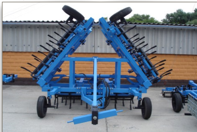
6,6m vontatott hidraulikus kombinátor
