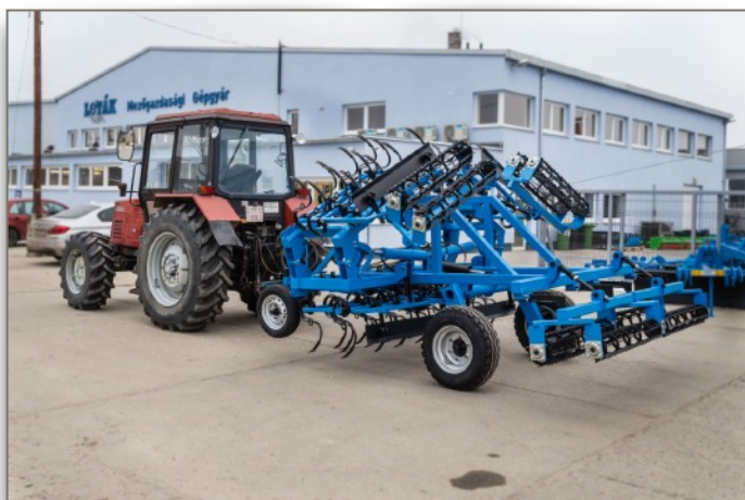
5,6m vontatott hidraulikus kombinátor
