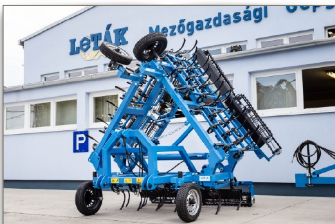
6,6m függesztett hidraulikus kombinátor
