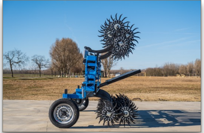
5m függesztett, hidraulikus csukással
