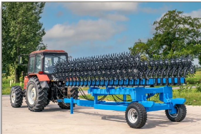
9m vontatott, hidraulikus csukással
