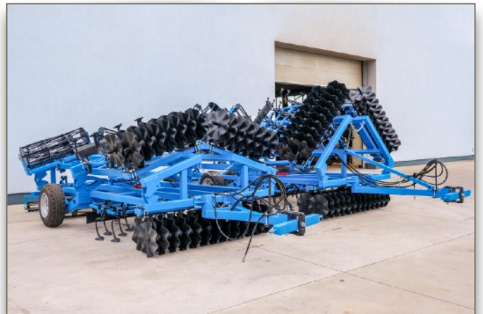
4,4m vontatott hidraulikus kompaktor
