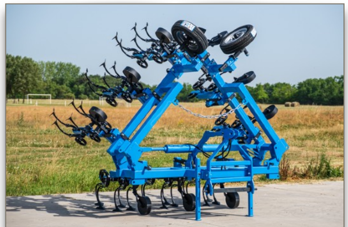
8 soros, rugóskapás hidraulikus kultivátor
