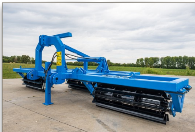
4m függesztett, hidraulikus csukással
