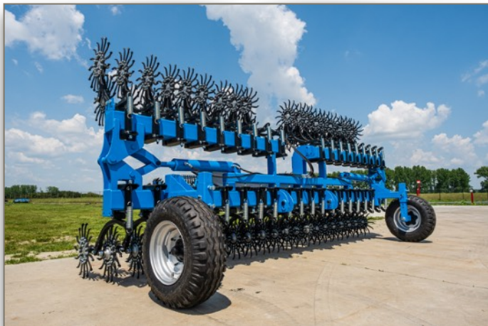
9m függesztett, hidraulikus csukással
