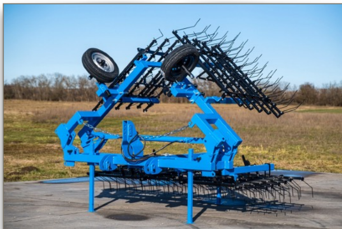
6,4m függesztett, hidraulikus csukással
