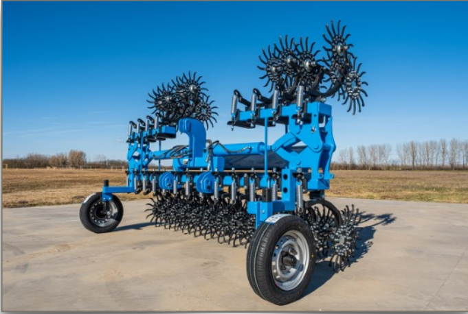
5m függesztett, hidraulikus csukással
