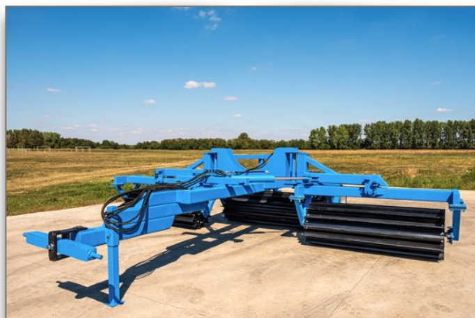
6m vontatott aprító henger, vízzel tölthető
