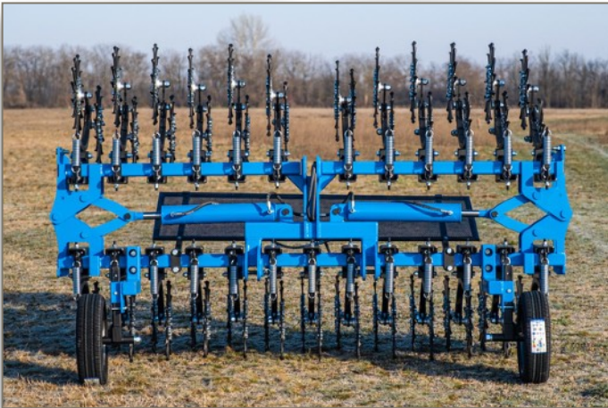
6m függesztett, hidraulikus csukással
