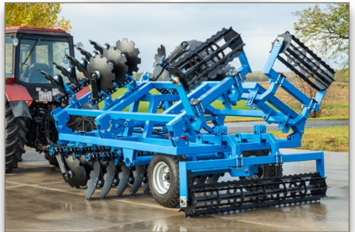
4,5m hydr., vontatott, csipkés hengerrel
