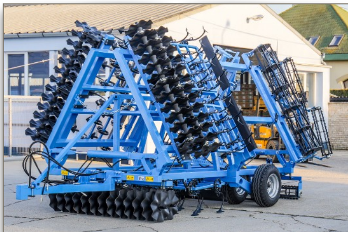
6,6m vontatott hidraulikus kompaktor
