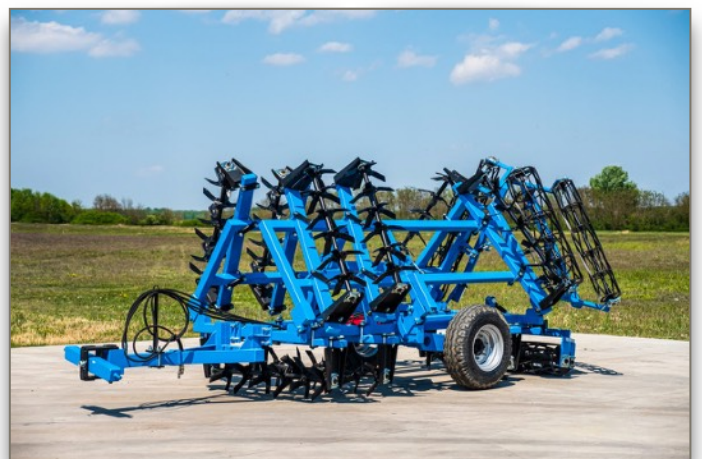
4,2m vontatott, hidraulikus ásóborona
