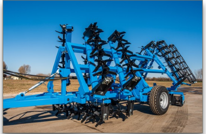
4,8m vontatott, hidraulikus ásóborona
