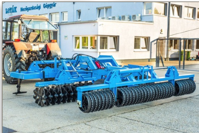
4m vontatott hidraulikus grubber
