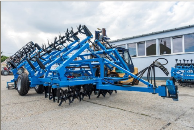
6,2m vontatott, hidraulikus ásóborona
