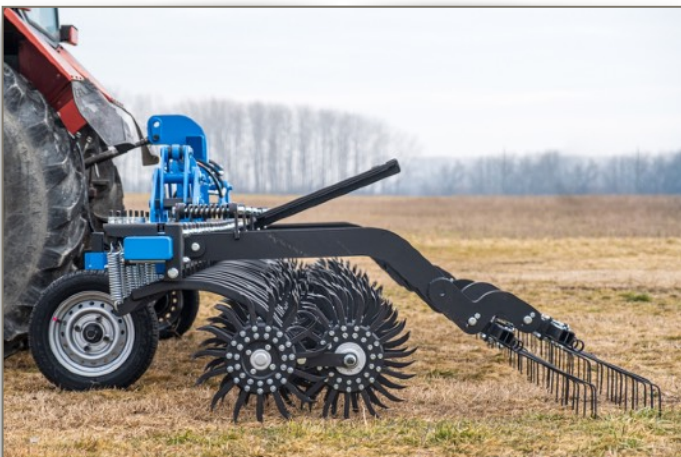
6m függesztett, gyomfésűvel
