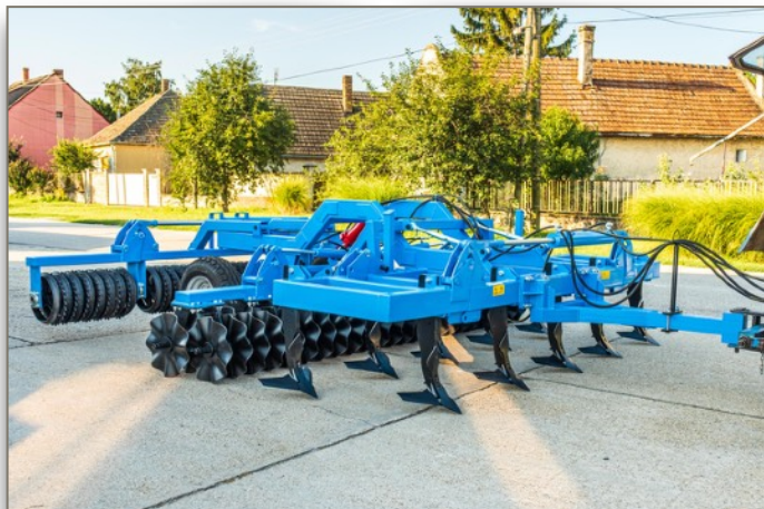
4m vontatott hidraulikus grubber
