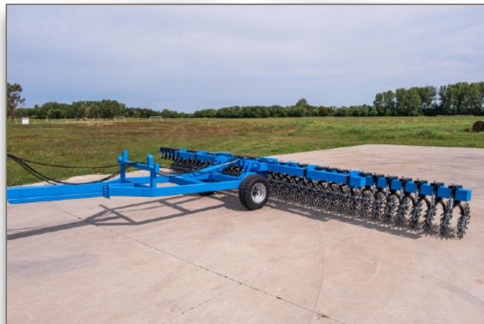
9m vontatott, hidraulikus csukással
