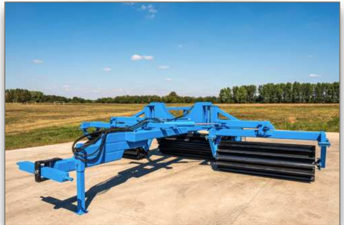
6m vontatott aprító henger, vízzel tölthető
