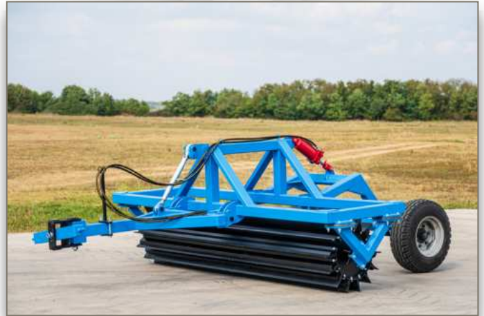
3m vontatott aprító henger, vízzel tölthető
