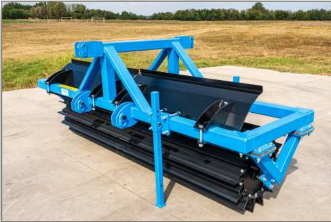
3m függ. aprító henger, vízzel tölthető
