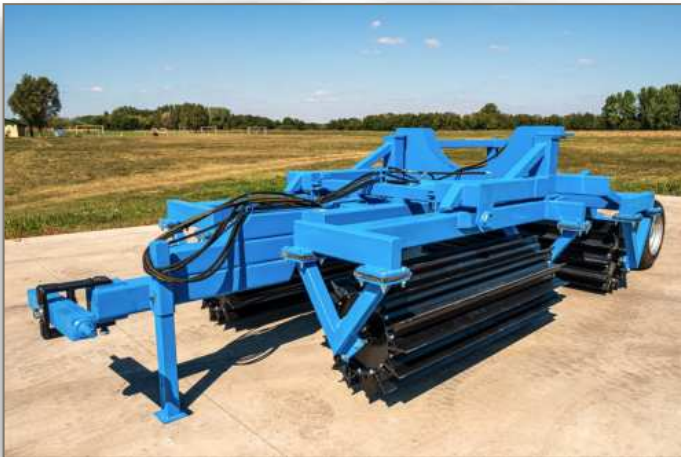
6m vontatott aprító henger, vízzel tölthető
